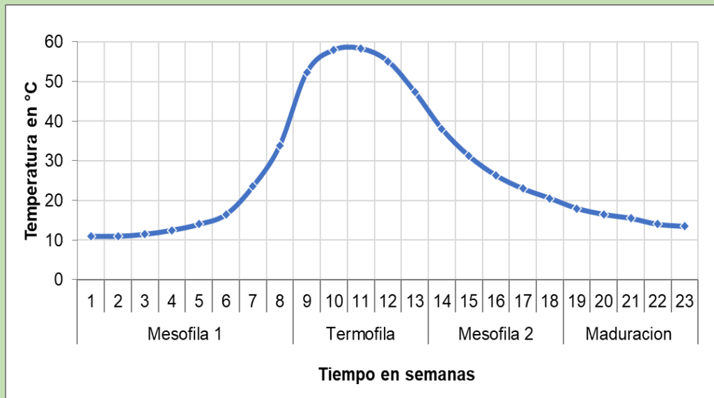
Gráfico 2. Curva de temperaturas referencial durante de proceso de compostaje en la localidad de Huari, Oruro.
